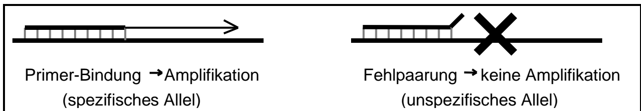
Abb. 1: Prinzip der SSP-PCR
