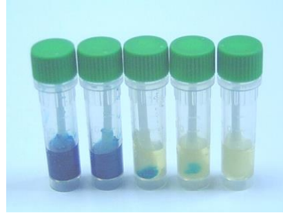
Ergebnisse des HemoCheck-S für unterschiedliche Blutmengen. Von links nach rechts: 100 µg, 10 µg, 1 µg, 0,1 µg, 0 µg. Alle Proben, außer dem Blindwert rechts, geben ein positives Ergebnis, erkennbar durch eine Blaufärbung.
