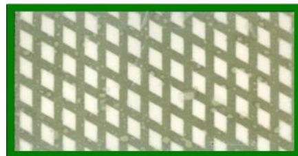
PASS Wassertropfen auf Indikator, Schirm verwenden oder Karte anders herum in Halter einsetzen
